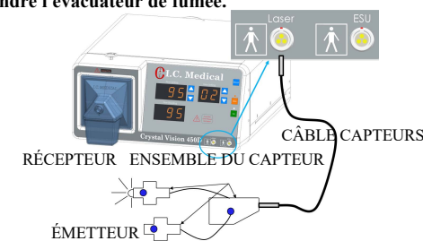
Figure 1 : Pièces d'assemblage du capteur et connexion au CRYSTAL VISION®.
